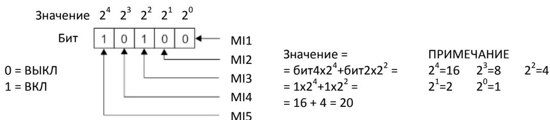
**02-51** Состояние выходов Заводская установка: Только чтение
