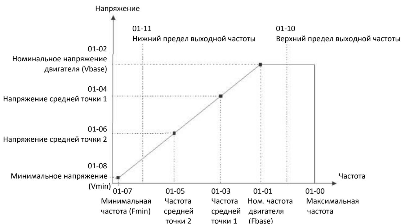
При пуске привод начинает работать с минимальной частоты (01-07), разгоняясь до заданного значения. Во время разгона нижний предел выходной частоты не действует.
