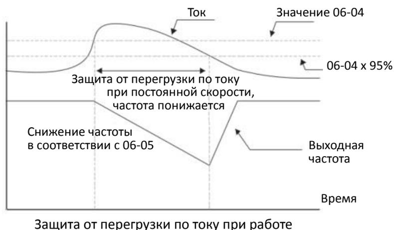
⚡ **06-05** Время разгона / замедления при защите от перегрузки по току при работе
