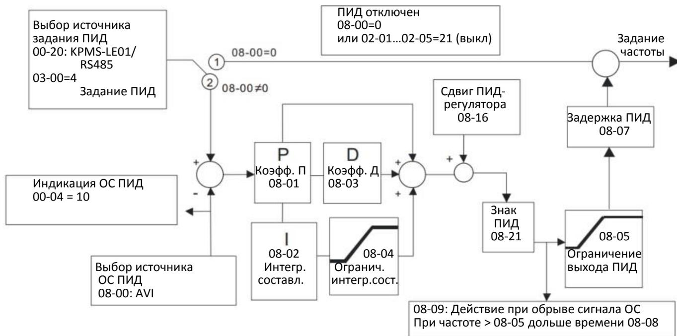
**Параллельная схема ПИД-регулятора**
