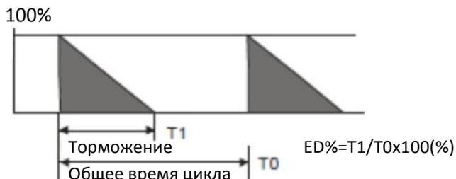
Комментарий: Расчётный ПВ (%) дает достаточно времени тормозному модулю и тормозному резистору рассеять тепло, выделившееся в результате торможения. Рекомендованное время цикла T0 составляет 1 мин.
