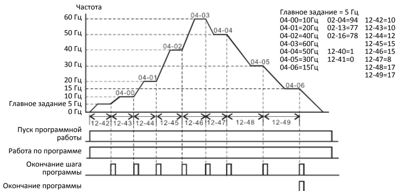
На диаграмме выше показан один полный цикл работы. Для повторения цикла снимите сигнал *Пуск программной работы* и подайте его вновь.
