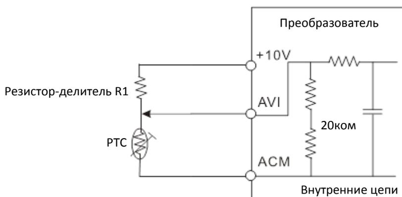
Возьмем для примера стандартный РТС: Пусть сопротивление срабатывания равно 1330 Ом, напряжение между клеммами +10V и АСМ равно 10,5В и резистор-делитель R1 равен 4,4 кОм
