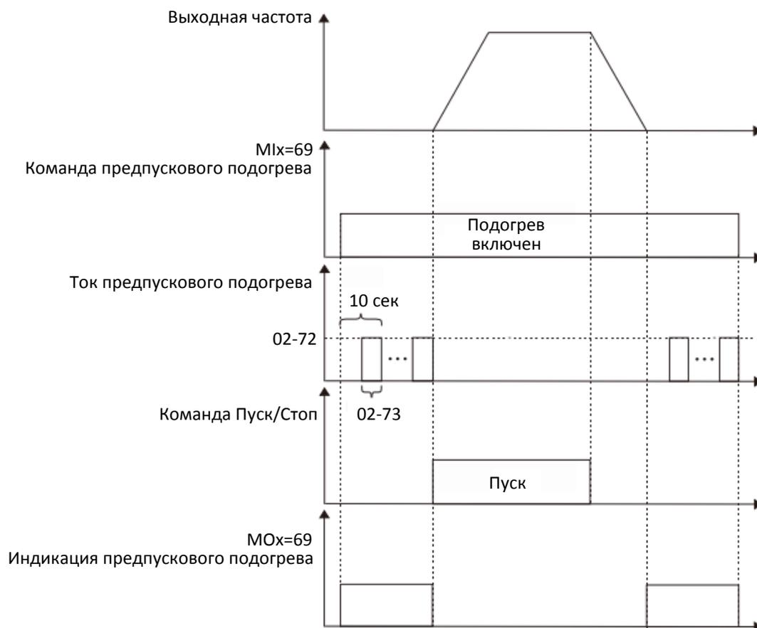
На рисунке ниже показано взаимодействие функций предпускового подогрева и торможения постоянным током.
