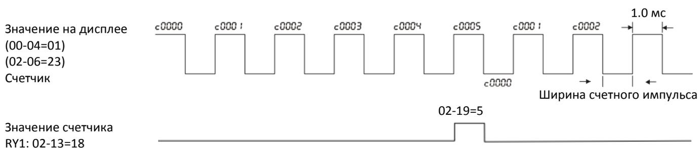
⚡ **02-20** Предварительное значение счетчика (без сброса на 0) Заводская установка: 0
