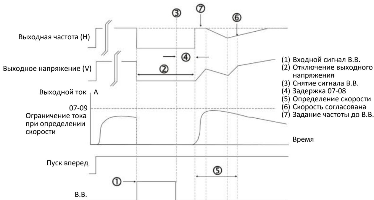
Определение скорости, начиная с последней выходной частоты
