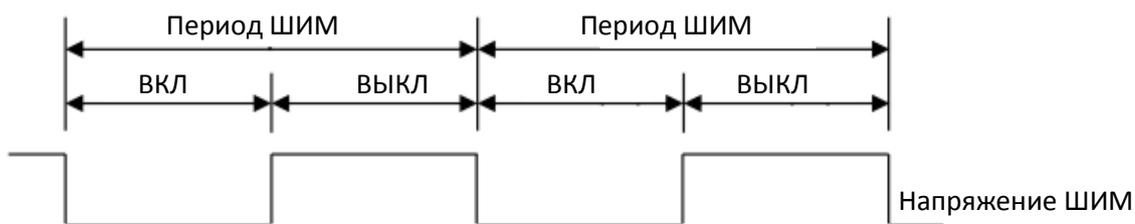
Задание частоты (Гц) = (время включения / период ШИМ) \* максимальная выходная частота (Гц)
