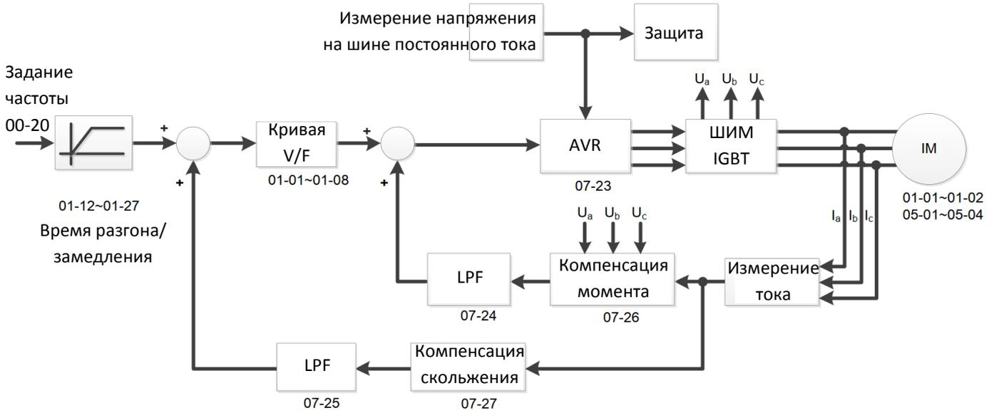
При 00-10=0 и 00-11=2 бездатчиковое векторное управление происходит по следующей структурной схеме:
