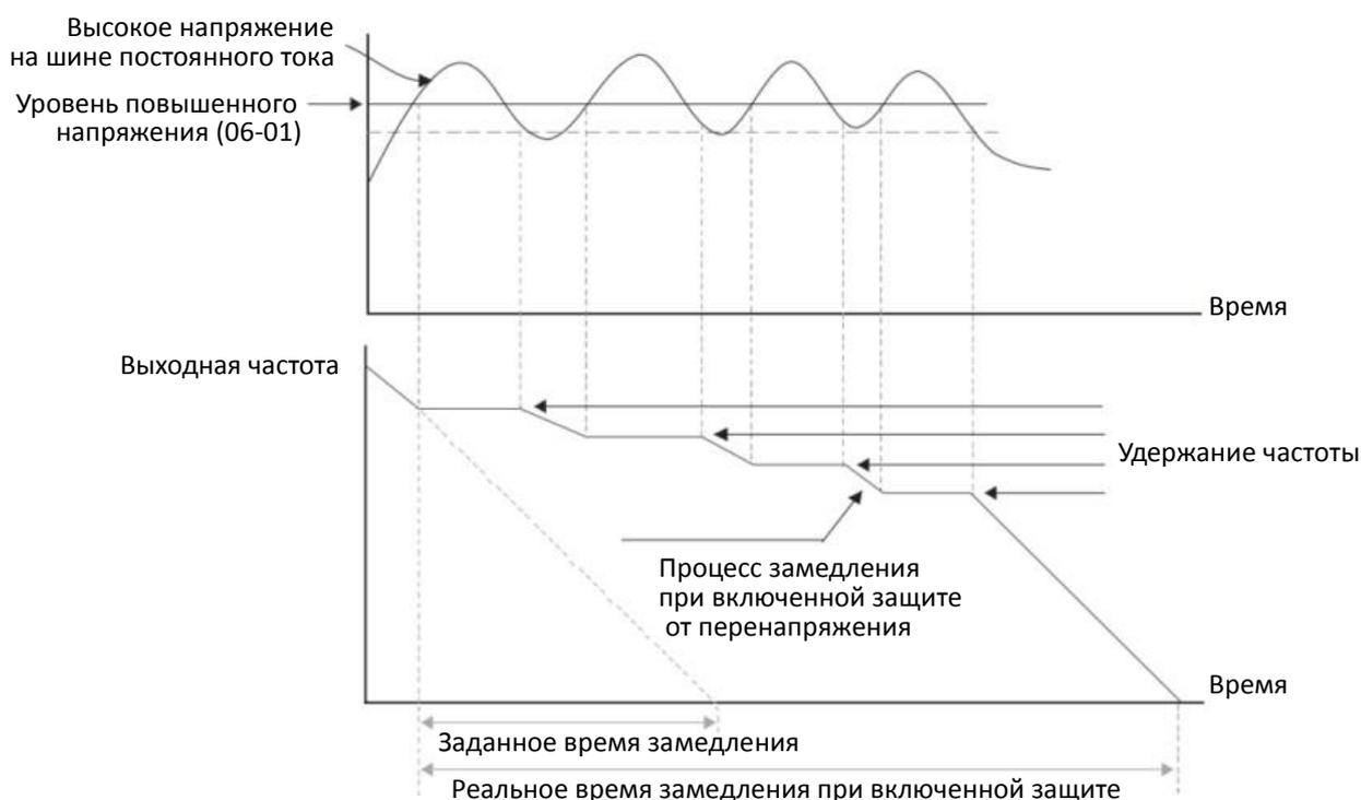
📖 Параметр 06-02 = 1: При использовании интеллектуальной защиты от перенапряжения при замедлении преобразователь поддерживает напряжение на шине постоянного тока во избежание перенапряжения.
