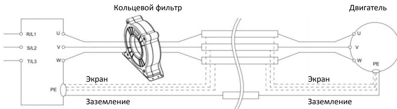
Рис. 7-18: Установка кольцевого фильтра с одним витком на экранированный кабель
