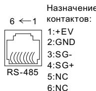
Преобразователь частоты может работать в коммуникационной сети по одному из протоколов Modbus, указанному в параметре 09-04.
