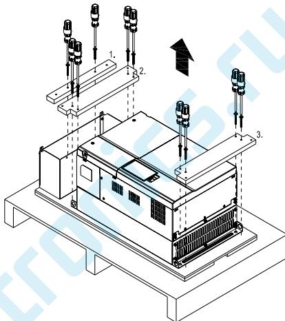
Снимите преобразователь с паллеты, закрепившись за специальные отверстия. После этого он готов к монтажу.
