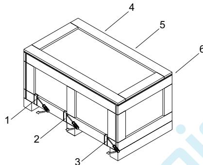
Снимите крышки ящика, извлеките пенопластовые уплотнители и техническую документацию.
