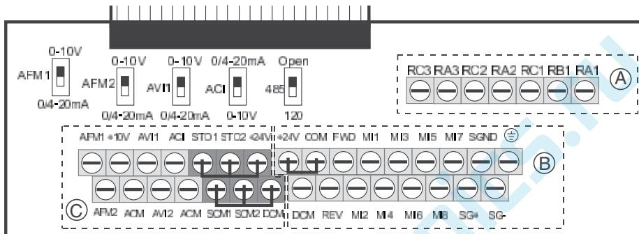
На рис. выше по умолчанию установлены перемычки STO1/STO2/+24V и SCM1/SCM2/DC. По умолчанию для дискретных входов установлен режим NPN (SINK), т.е. установлена перемычка на клеммах +24V и COM ; Подробнее см. в главе «Подключение».
