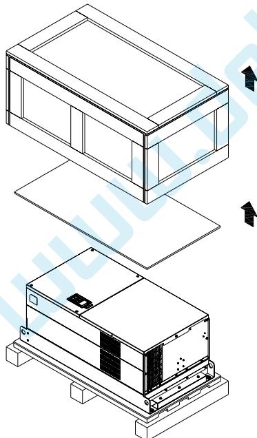
Снимите крышки ящика, извлеките пенопластовые и резиновые уплотнители и техническую документацию.
