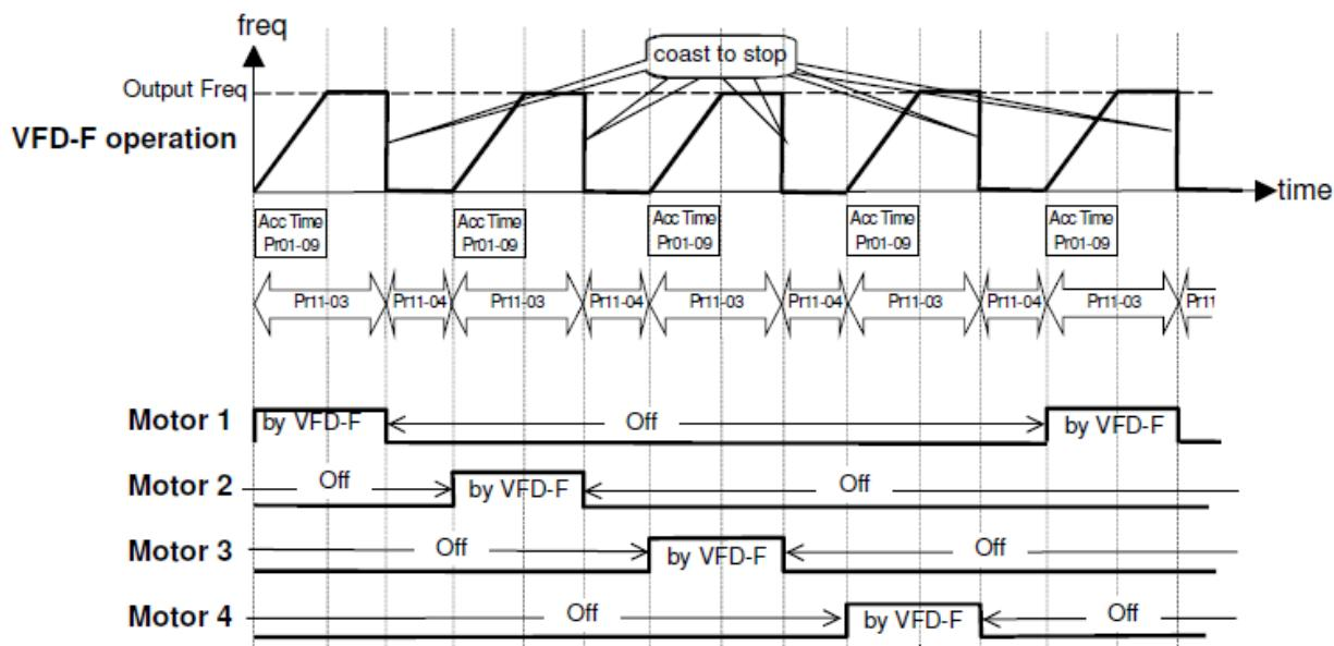
Каждый мотор подключается к VFD-F на определённое параметром Pr11-03 время. Далее мотор отключается от VFD-F и через время задержки (параметр Pr11-04) производится подключение следующего мотора. И так, через время,
