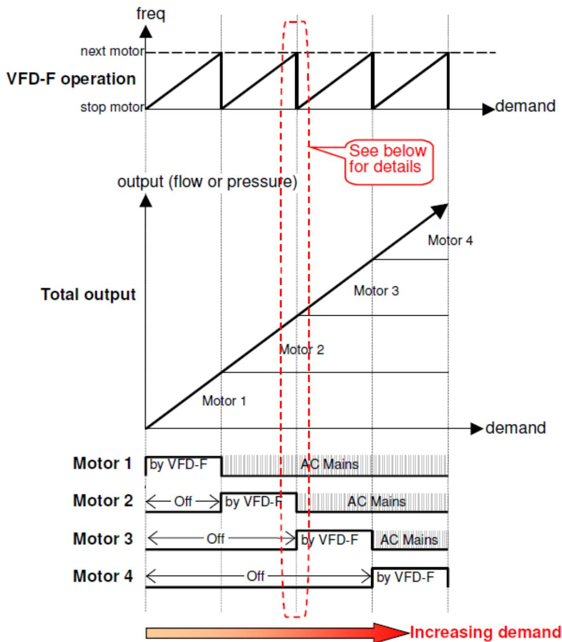
После работы на этой частоте, в течении времени, определяемого Pr11-05 он отключается от VFD-F, вращается свободно без принудительного торможения и через время, определяемое Pr11-04 подключается напрямую к сети. Далее, аналогичная коммутация производится со следующим мотором и т.д.
