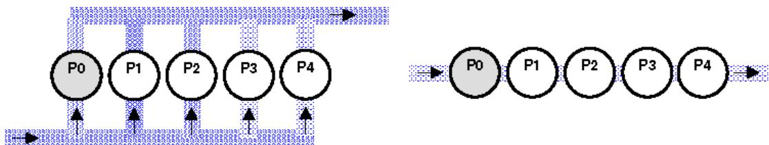
Такой режим применяется тогда, когда одним преобразователем частоты небольшой мощности необходимо управлять несколькими насосами. Преимущество заключается в том, что преобразователь небольшой мощности может регулировать в широком диапазоне уровень давления или производительности, при этом работает только необходимое число насосов
