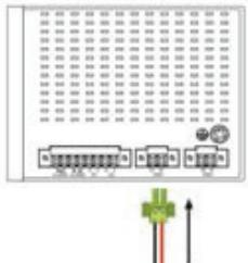
註：請務必正確接上DVS底部的接地端子，可提高抗EMI雜訊能力。
