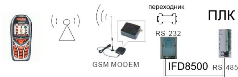
Данная конфигурация позволяет управлять контроллером путем отправки SMS-сообщений с сотового телефона, а также принимать SMS-сообщения, которые будет отправлять контроллер при возникновении соответствующих ситуаций на управляемом объекте. В данном случае GSM-модем имеет порт RS232, а подключается к порту COM2 (RS485) контроллера. Следовательно, необходимо применение конвертера интерфейсов RS232 <-> RS485 IFD8500, который подключается к GSM-модему через переходник, описанный выше.
