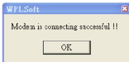
Данное сообщение сигнализирует, что установлен канал связи между GSM-модемами и теперь можно осуществлять загрузку/выгрузку программы и on-line мониторинг как если бы ПЛК был подключен напрямую к ПК по кабелю. Единственным отличием является время задержки в отображении изменений.
