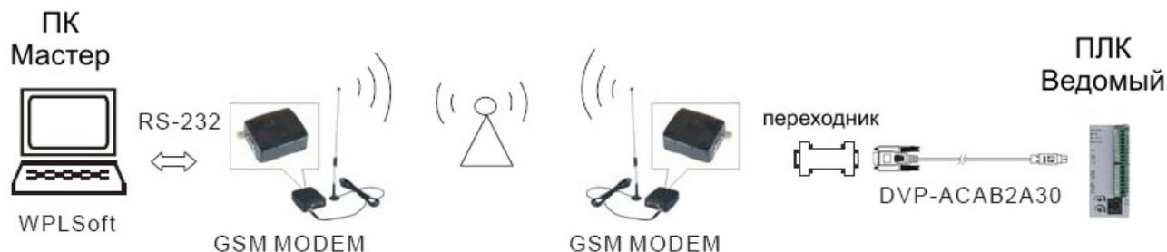
Данная конфигурация позволяет загружать/выгружать рабочую программу контроллера и осуществлять on-line мониторинг. GSM-модем подключается через переходник и штатный соединительный кабель к порту COM1 (RS232) контроллера. Среда программирования WPLSoft должна быть установлена на ПК, который в данной конфигурации будет выступать Мастером по отношению к ПЛК. К компьютеру также должен быть подсоединен GSM-модем через порт RS232 или USB (семейство TELEOFIS имеет модификацию GSM-модема с портом USB).
