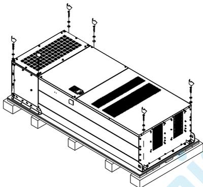
Открутите 6 винтов М6 с двух сторон и удалите 2 планки как показано на рис. ниже. Винты и планки могут быть использованы для внешнего крепления преобразователя.
