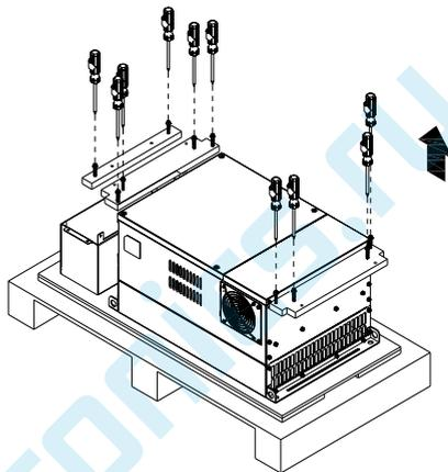
Извлеките преобразователь из ящика, закрепившись за специальные отверстия. После этого он готов к монтажу.
