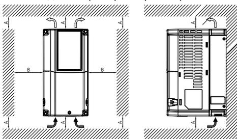
Рис. 2. Несколько ПЧ: Установка без взаимовлияния (типоразмеры G, H)
