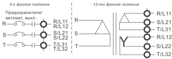
Для снижения уровня пульсаций и гальванической развязки ПЧ и питающей сети, а также для удобства подвода питания 6-ю проводами меньшего сечения (вместо трех проводов, как в классической схеме) в типоразмерах G и H предусмотрена возможность питания от 6-ти выходных обмоток трансформатора (трансформатор в комплект поставки не входит).
