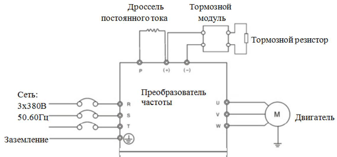
Рис. 5 Схема подключения тормозного резистора к преобразователю частоты через тормозной модуль (средние и большие мощности ПЧ)
