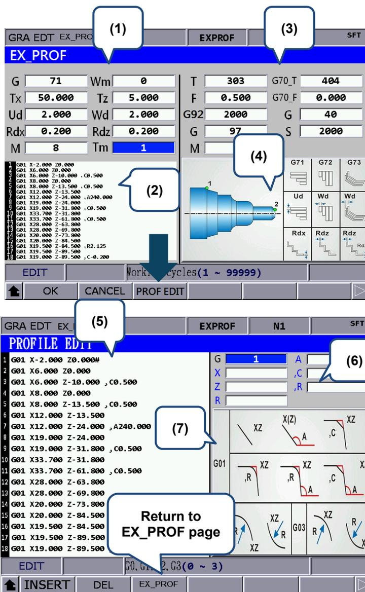
(1) Machining parameters setting
