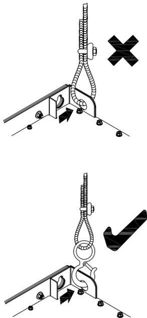
Обеспечьте выполнение условий указанных на рис. ниже (угол между вертикалью и тросом не должен превышать  $45^\circ$ ).
