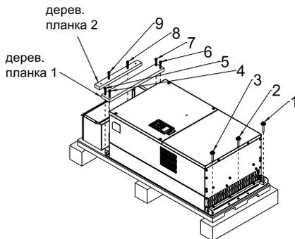
Снимите преобразователь с паллеты, закрепившись за специальные отверстия. После этого он готов к монтажу.
