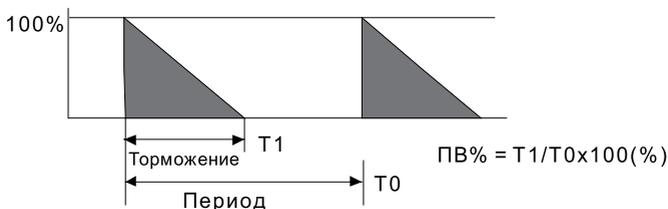
2. Для предотвращения перегрузки тормозного резистора рекомендуется установить в его цепи тепловое реле. Контакт теплового реле должен отключать ПЧ с помощью контактора (МС) от питающей сети!
