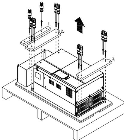
Снимите преобразователь с паллеты, закрепившись за специальные отверстия. После этого он готов к монтажу.
