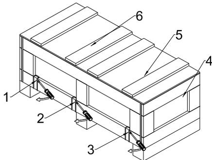
Снимите крышку ящика, извлеките пенопластовые уплотнители и техническую документацию.
