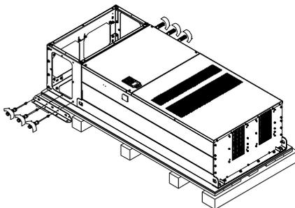
**Внешнее крепление преобразователя частоты.** (Пропустите этот шаг, если Вам не требуется внешнее крепление). Открутите 8 винтов М8 с обеих сторон и установите планки, снятые на предыдущем шаге, и закрепите их с помощью 8 винтов М8. (см. рис.) Момент затяжки: 150~180 кг\*см (130.20~156.24 фунт\*дюйм).
