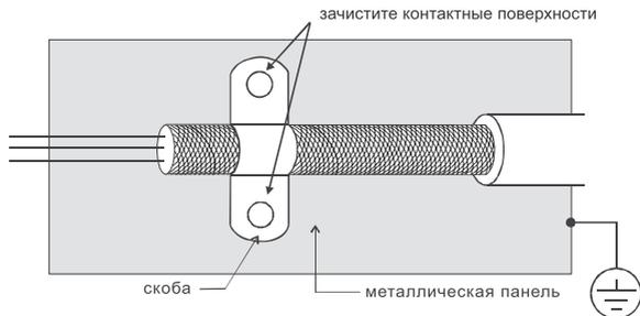
Заземление экрана на обоих концах кабеля
