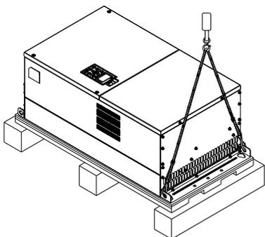
Снимите преобразователь с паллеты, закрепившись за специальные отверстия. После этого он готов к монтажу.
