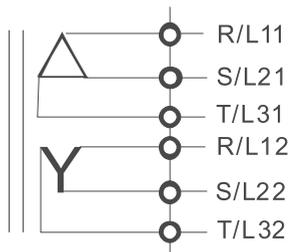
При шестипроводном питании необходимо снять перемычки с клемм R, S, T.
