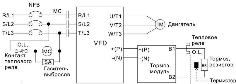
Прим.1: Когда используется ПЧ с дросселем постоянного тока, см. схему подключения в руководстве по эксплуатации ПЧ для подключения клеммы +(P) торм. модуля.
