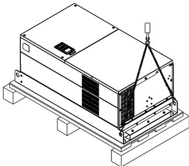
Снимите преобразователь с паллеты, закрепившись за специальные отверстия. После этого он готов к монтажу.
