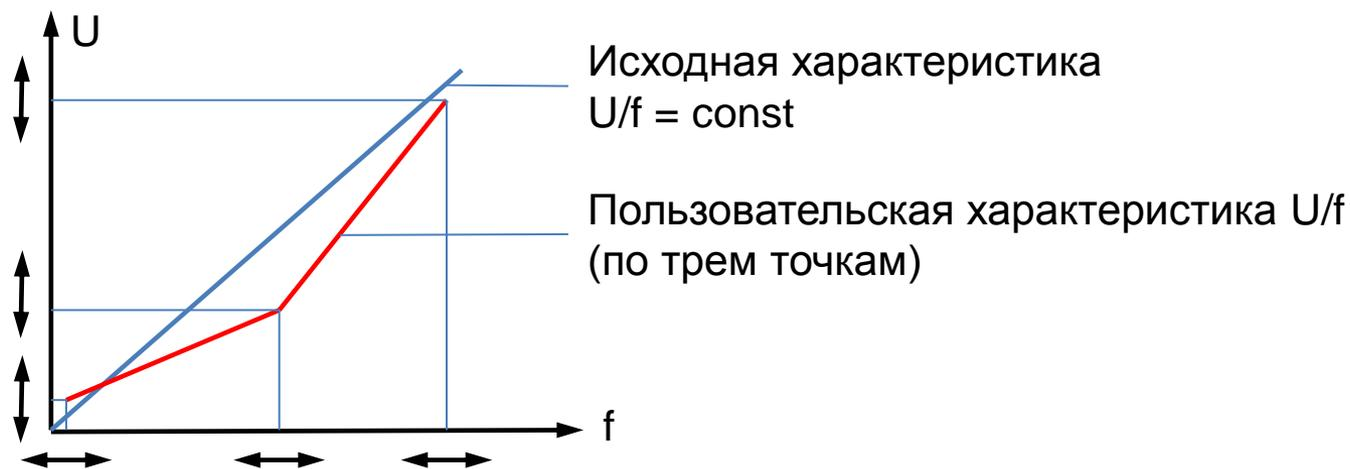
Корректировка зависимости U/f позволяет точнее настроить привод на конкретный механизм и повысить уровень энергосбережения.
