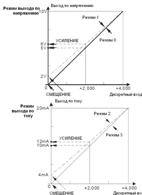
Режим 0 для CR#1: GAIN = 5В(2000<sub>МШО</sub>), OFFSET=0В (0<sub>МШО</sub>)
