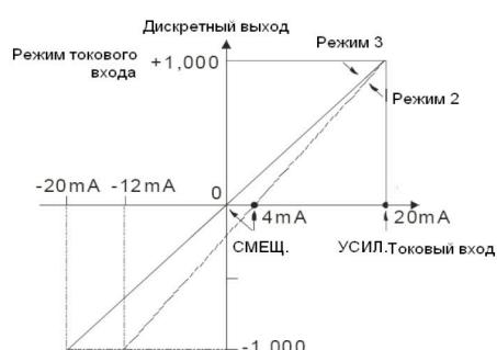
Режим 0 для CR#1: GAIN = 5B(1000<sub>МШО</sub>), OFFSET=0B (0<sub>МШО</sub>)
