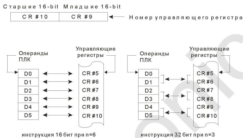
3. В моделях DVP-SS, логическая переменная M1083 не предусмотрена. При выполнении инструкции FROM/TO, все прерывания (включая внешние и внутренние прерывания программы обработки прерываний) будут заблокированы. Все прерывания будут выполнены после завершения работы инструкции FROM/TO. Инструкция FROM/TO может быть также выполнена в программе обработки прерываний.
