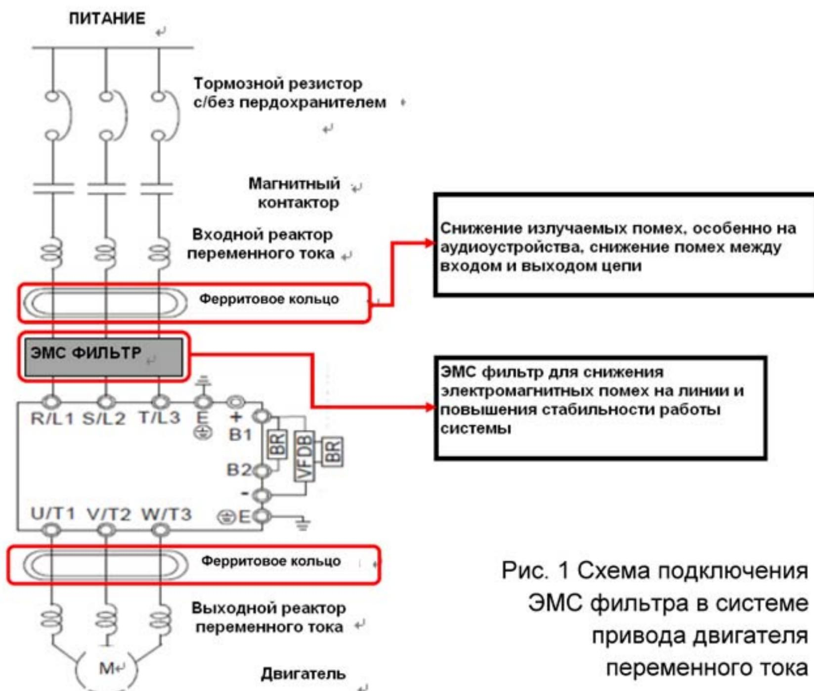
Рис. 1 Схема подключения ЭМС фильтра в системе привода двигателя переменного тока
