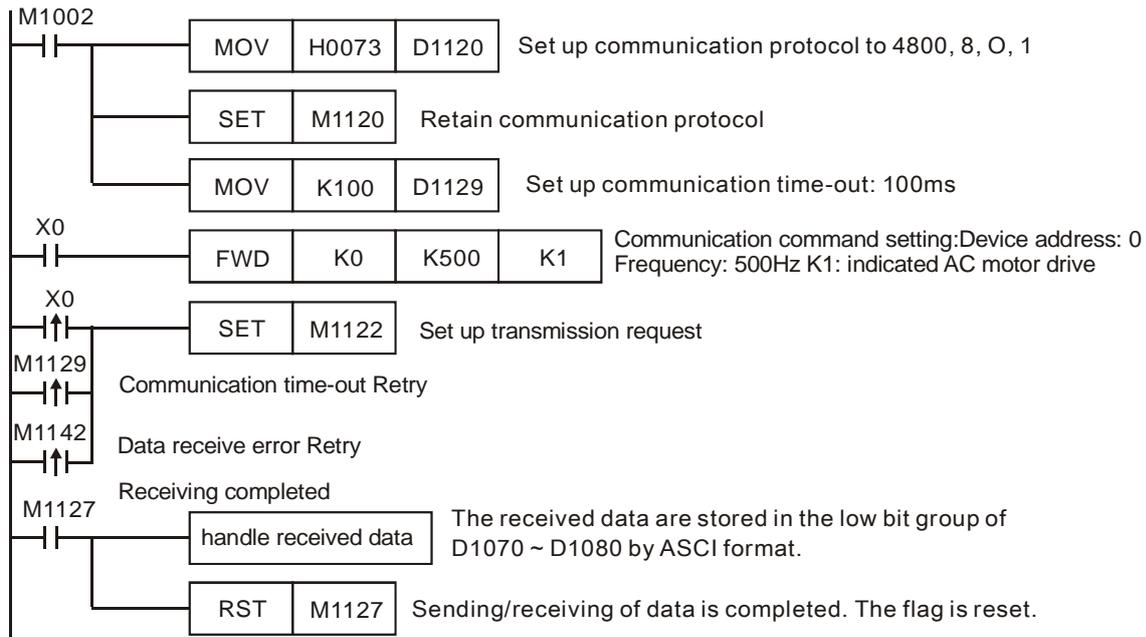
PLC ⇒ VFD-A, PLC sends: “C ♥ ☺ 0001 0500 ”
