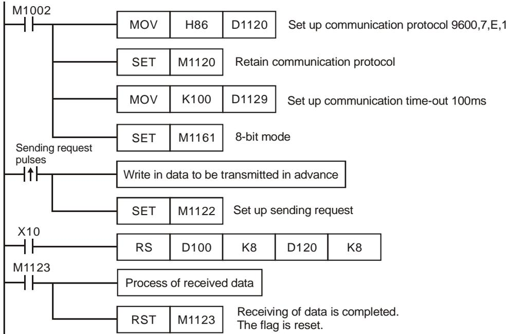
PLC ⇒ VFD-B, PLC sends: **01 06 2000 0012 02 07**
