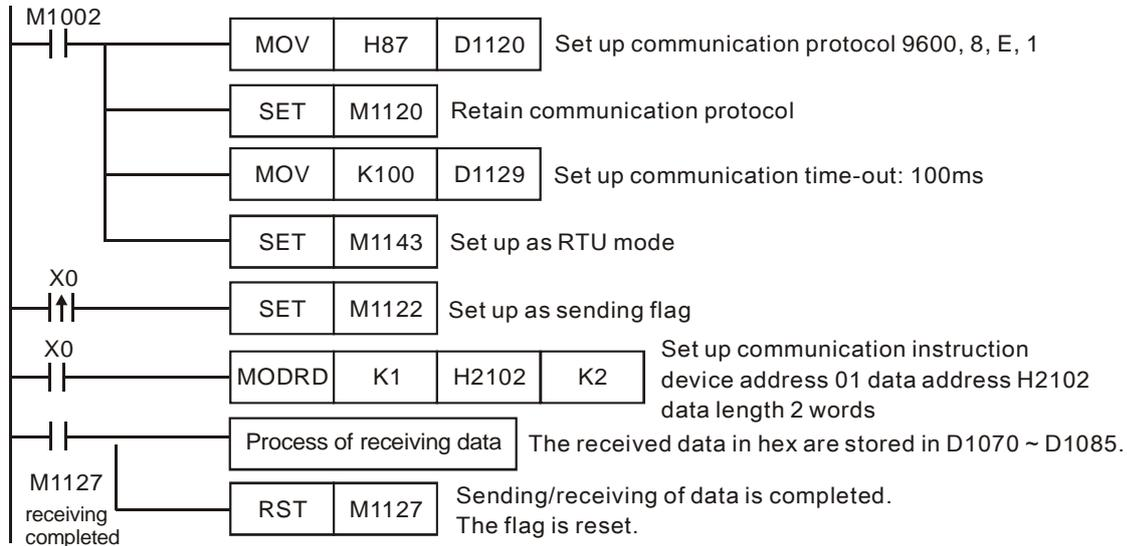
PLC ⇒ VFD-S, PLC sends: **01 03 2102 0002 6F F7**
