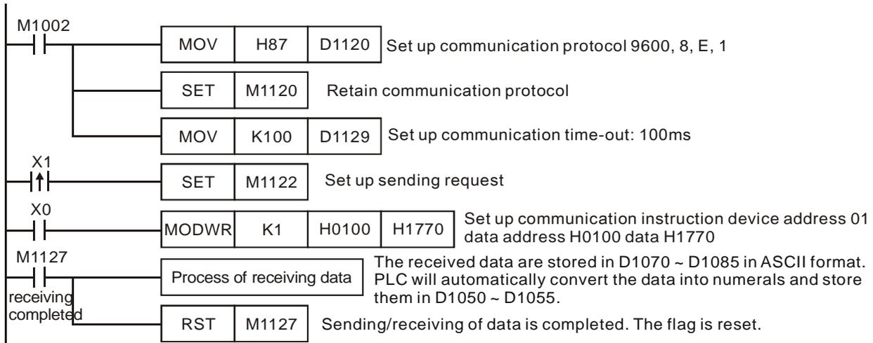
PLC ⇒ VFD-B, PLC sends: “ 01 06 0100 1770 71 ”
