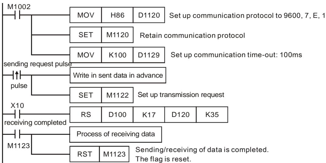
PLC ⇨ VFD-S, PLC sends: “: 01 03 2101 0006 D4 CR LF ”
