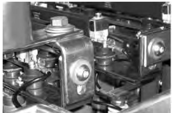
2. Ослабьте с обеих сторон фазового блока монтажные болты, которые крепят фазовый блок к лотку.
