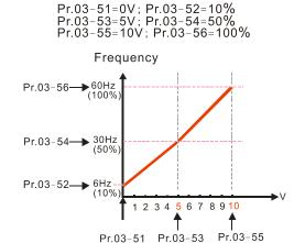
Pr.03-51=1V; Pr.03-52=0% Pr.03-53=5V; Pr.03-54=50% Pr.03-55=10V; Pr.03-56=100%
