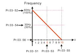
Pr.03-51=1V; Pr.03-52=10% Pr.03-53=5V; Pr.03-54=50% Pr.03-55=10V; Pr.03-56=100%
