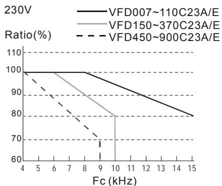
Pr.06-55=0 или 2 (40°C: UL open-type, 30°C: UL type 1 при установке стенка к стенке)
