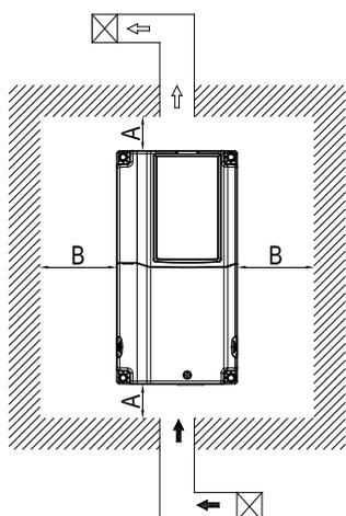
В таблице указаны требуемые значения охлаждающего воздушного потока, при установке одного ПЧ в шкафу. При установке нескольких ПЧ, воздушный поток для одного ПЧ умножается на количество ПЧ в шкафу.
