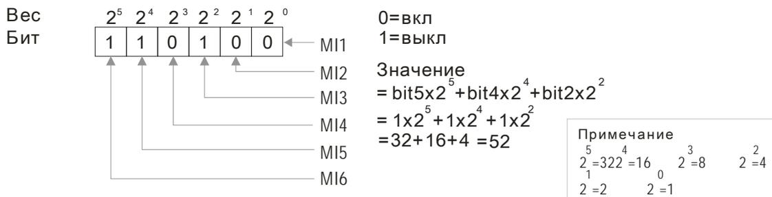
02-51 Индикация состояния дискретных выходов
