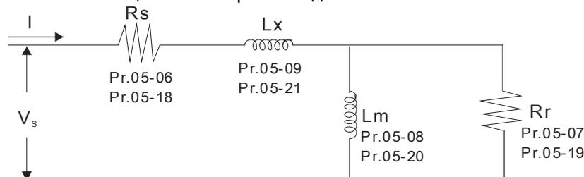
Если Pr.05-00 = 2, то необходимо ввести значения тока холостого хода в параметр 05-05 для двигателя 1 и в параметр 05-17 для двигателя 2.
