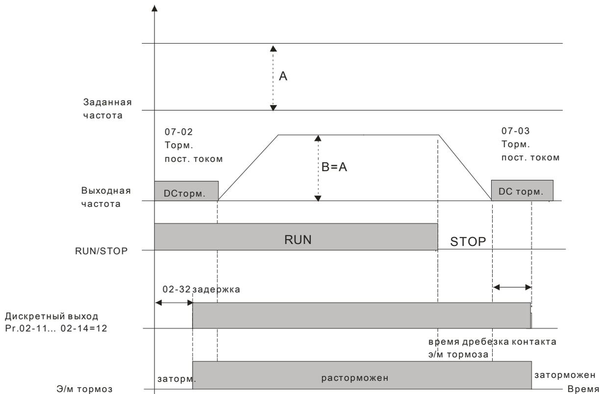
Если этот параметр используется без торможения постоянным током, то он будет проигнорирован. См. рис.
