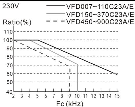
Pr.06-55=0 или 2 (40°C: UL open-type, 30°C: UL type 1 при установке стенка к стенке)
