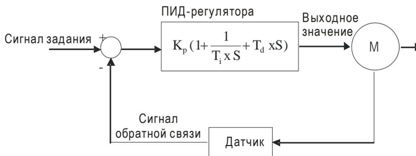
$K_p$ : Пропорц. коэф. (P)     $T_i$ : Время интегрир-я (I)     $T_d$ : Время дифф-я (D)    S: Оператор
