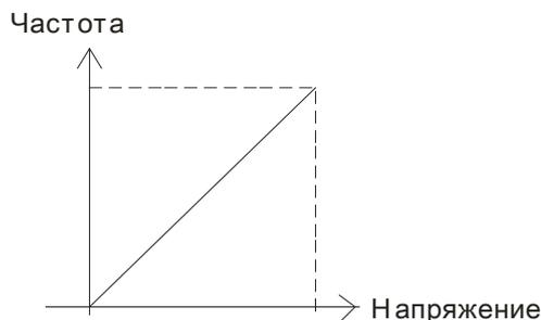
$$F_{\text{зад}} = [(AY + \text{смещение}) \cdot \text{усиление}] * \frac{F_{\text{max}}(01-00)}{10V \text{ или } 16mA}$$
