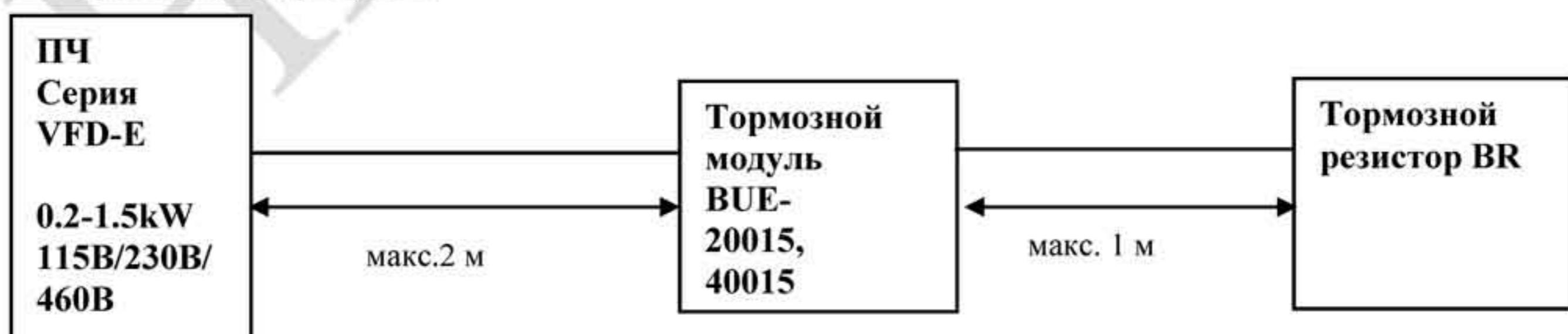
5. Горючие предметы, жидкости и газы не должны находиться вблизи тормозного резистора. Желательно его монтировать в отдельном металлическом корпусе с принудительной вентиляцией.
