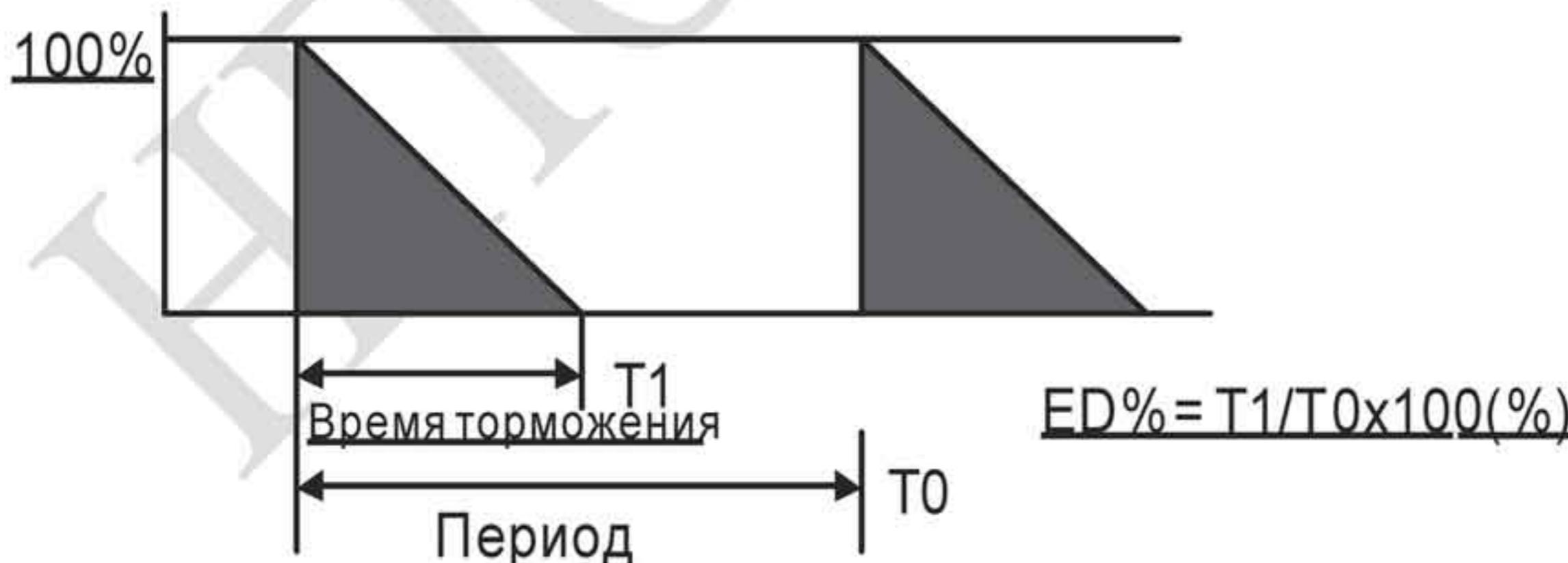
Величина цикла торможения ED% определяет минимальный период торможения, при котором произойдет полное рассеяние тепла на тормозных модулях и резисторах, выделенное за время торможения. При нагреве тормозного резистора его сопротивление увеличивается с ростом температуры и соответственно уменьшается тормозной момент
