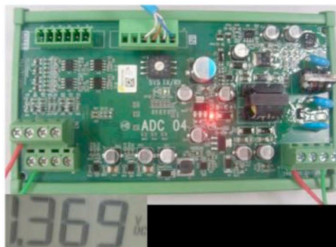
Рис. 2.2.6. Показание вольтметра на входе платы аналоговых входов
